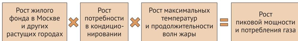
**Рис. 1.** Схема повышения нагрузки на энергосистемы в связи с увеличением потребления электроэнергии на вентиляцию и кондиционирование во время волн жары
